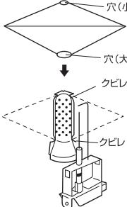
注意:マントルに穴があいていたり、割れていると、漏れ出た炎により、グローブの割れ、変色、変形や本体が異常過熱され故障や事故の原因になります。必ず新しいマントルと取り替えてください。
