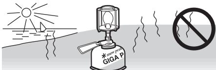
■ 理由 ■ 直射日光を受けた砂浜や川原の石あるいは舗装路面上は高温になっています。その上に容器を放置したり、器具を使用すると容器が過熱され内圧が急激に上昇し異常燃焼をしたり爆発することがあります。
