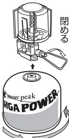
警告:取り付けの前には必ず器具栓の取り付けネジ部及びOリングの異常が無いか確認してください。異常の際は容器の取付けを絶対しないでください。
